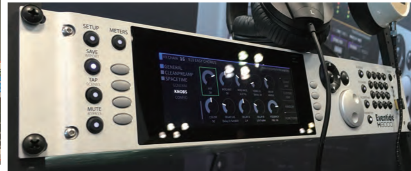
「H9000」のフロントパネルデザイン。PC やモバイル・デバイスからのコントロール・アプリケーションおよび DAW からのリモート・プラグインなども用意される。
