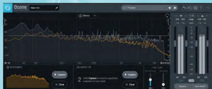
画面9: リファレンスとする曲の雰囲気を他の曲に施すことができるMatch EQ
